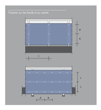
Nous recommandons, pour des raisons d'esthétique, de réduire les entraxes de fixation et les portées indiqués d'environ 5 à 10 % pour les bâtiments de plus de 8 m (± 315 in) de haut. Pour les bâtiments de plus de 20 m (± 787 in) de haut, nous recommandons de réduire les valeurs indiquées de 10 à 15 % et de ne plus employer de panneau de 6 mm (± 1/4 in) d'épaisseur.
