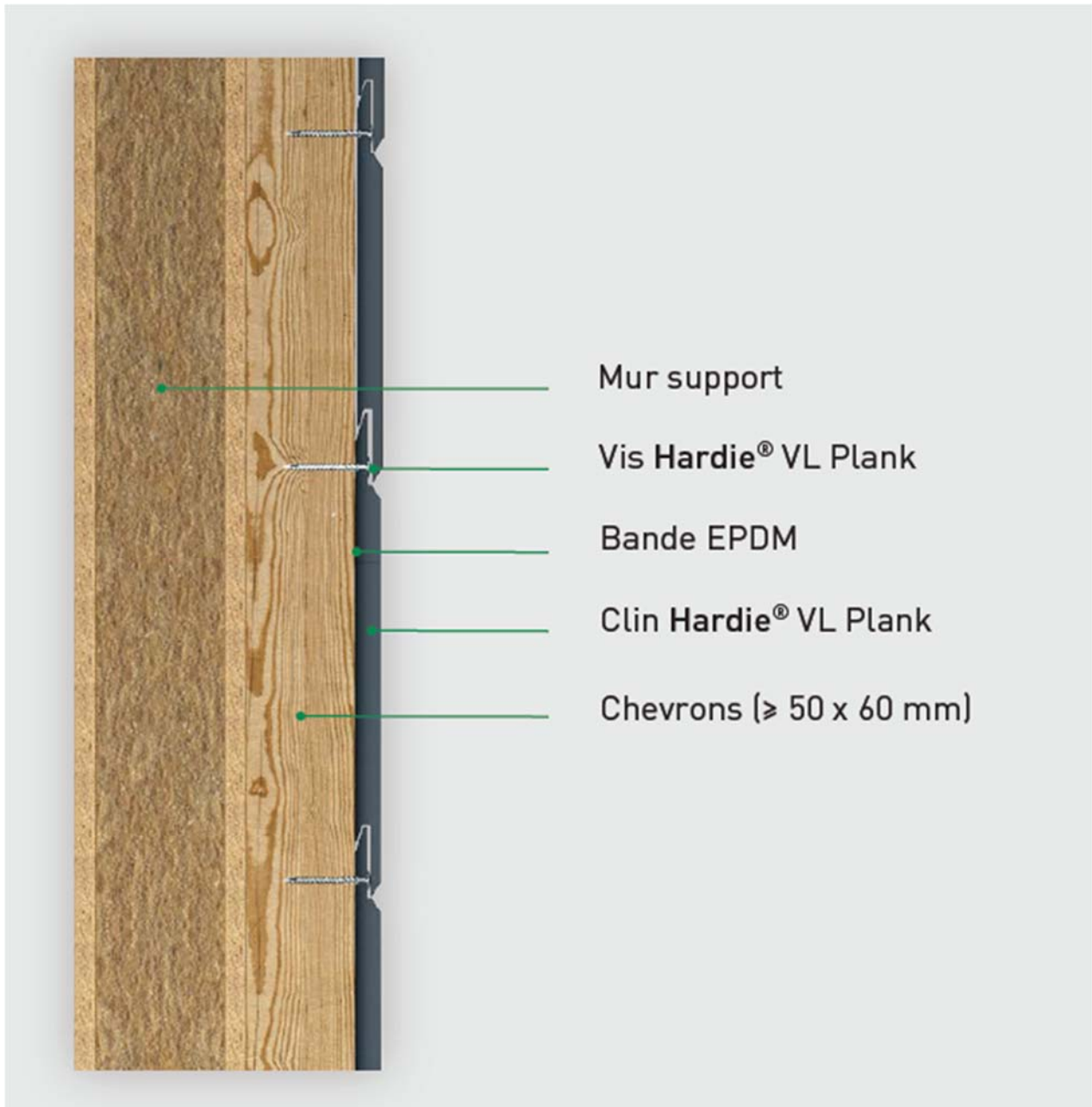
Figure 37 - Coupe sur COB coupe verticale (pose horizontale des clins)
