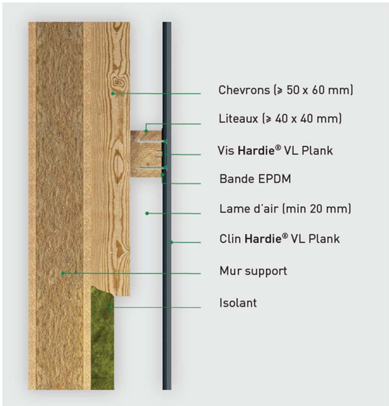
Figure 38 - Coupe sur COB coupe verticale (pose verticale des clins)
