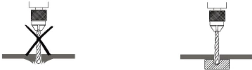
Les trous de grand diamètre destinés à la suspension ou à l'installation de quincaillerie doivent être percés à l'aide d'outils de type forets à étage.
